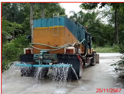
(13) รถบรรทุกน้ำฉีดพรมเส้นทางขนส่งแร่
